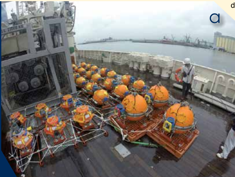
(a) Batería de instrumentos a bordo del buque oceanográfico japonés Shinsei Maru . Sensores de presión a la izquierda y sismómetros submarinos a la derecha. (b) Lanzamiento de un sismómetro de fondo oceánico por investigadores japoneses frente a las costas de Sendai en Japón. (c) Extracción de un núcleo de sedimentos del fondo oceánico.
