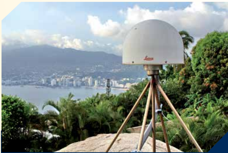
Estación mareográfica del Instituto de Geofísica y estación GPS permanente localizada en Acapulco, Guerrero.
