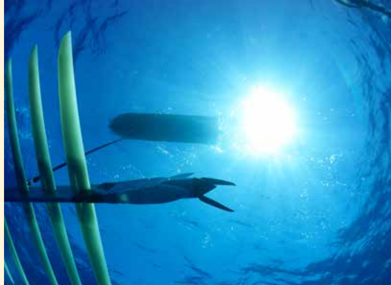
Otra vista del planeador de olas (Wave Glider) para realizar mediciones GPS-acústicas en el fondo del mar frente a las costas de la brecha sísmica de Guerrero. Imagen cortesía Liquid Robotics.
