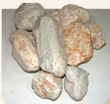
La roca es uno de los materiales utilizados en la construcción de diques-arrecife.
