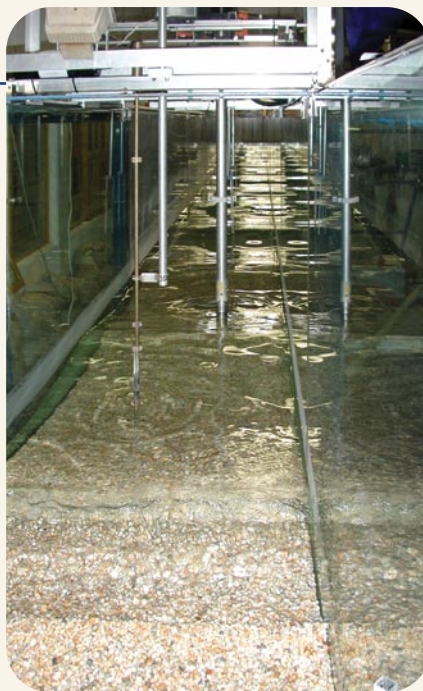
El doctor Edgar Mendoza Baldwin está a cargo del laboratorio donde se analizan los posibles escenarios (oleaje, viento, corrientes) y las condiciones que permitan una correcta colocación de diques-arrecife.
