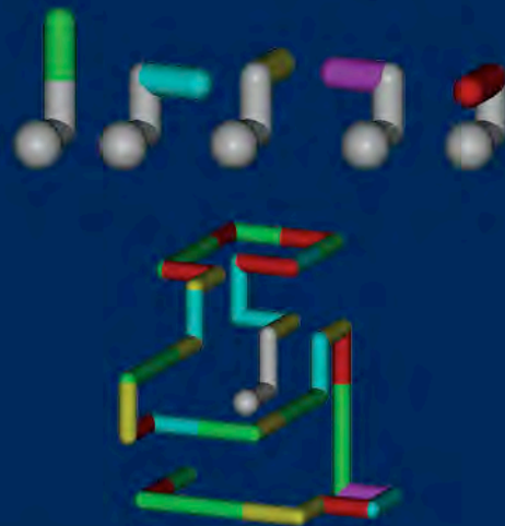
Figura 7. Definición de los elementos de código de cadenas 3D en la parte superior, de izquierda a derecha: "0", "1", "2", "3" y "4", respectivamente. En la parte inferior de la figura un ejemplo de una curva discreta.
