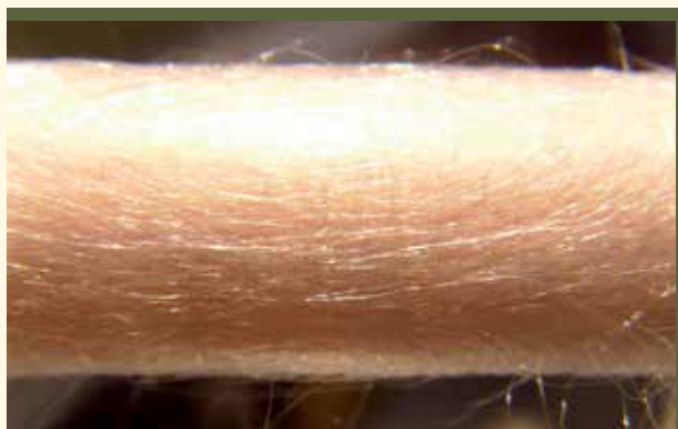
Imágenes de microscopía electrónica de barrido de las fibras poliméricas obtenidas por la técnica de electrotejido para los poliuretanos que se usarán como sustitutos de menisco.
